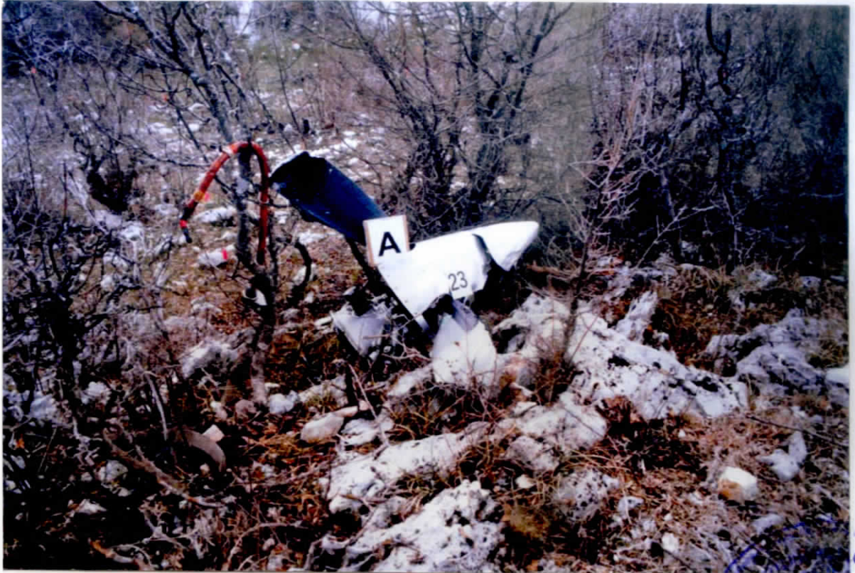
Slika 8.8: Elisa desnog motora sa reduktorom
